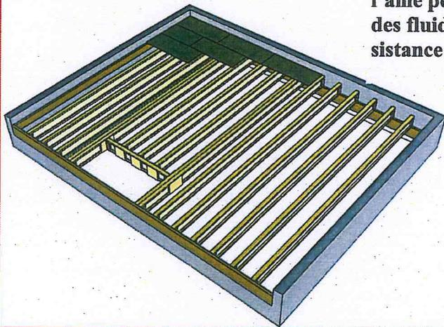
La Mega Poutre s'utilise en solives pour les planchers, l'âme peut être découpée facilement pour le passage des fluides. La fabrication industrielle permet une résistance uniforme des poutres
